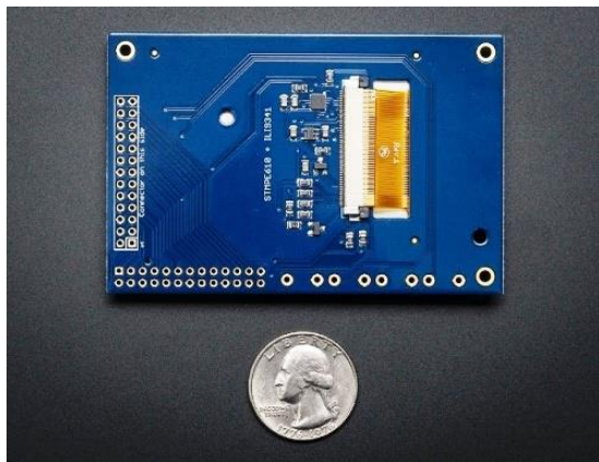
Рис.10.2 Зворотна сторона сенсорного екрану
