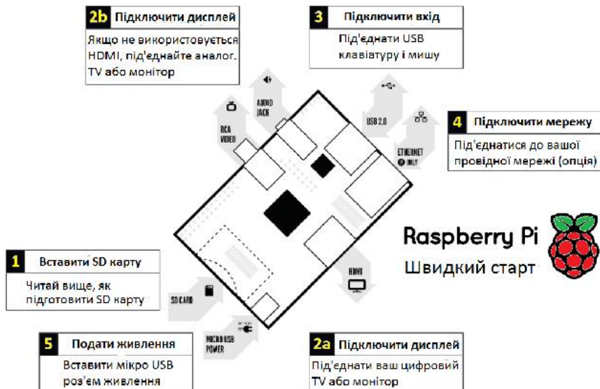
Рис.1.5 Послідовність приєднання обладнання
