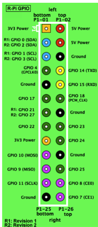
Рис.7.1 Позначення виводів GPIO
